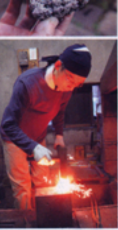
「ふい」を吹いて鋼材を熱し、的 て鍛える。鍛冶場ならではの光 景だが、この過程は今紹介し た初級編では扱われない。
