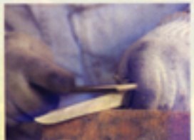
上／灼熱の刀身を一気に水に入 れる。刃文が作られるのと同 時に「伏せ」が現れてまっすぐになる 下／刃と反対側の背の部分（「棟」 という）にやすりをかけて模様を つける。序盤の作業だ
