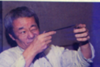
焼き入れの後、刃文を見極める高野刀匠。「し い刀には感動があるんですよ」と話す。刀鍛 冶体験をきっかけに弟子入りした人も2人いる
